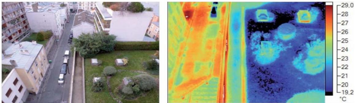
Figure 1- Thermographie d'une toiture végétale \_ Source : Apur 2011 © Apur
