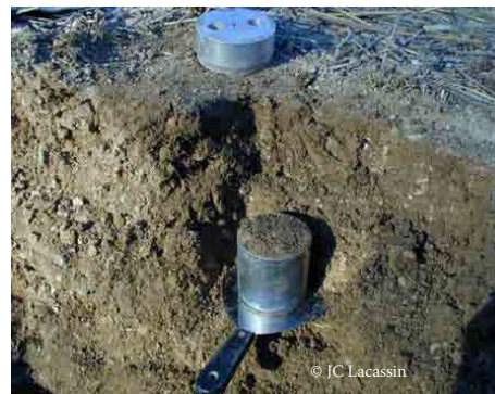
La teneur en eau du sol peut être mesurée en faisant la différence entre la masse humide et la masse sèche d'un volume de terre connu prélevé à l'aide d'un cylindre
