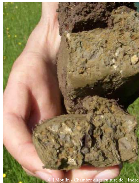
Sur les échantillons du bas relatifs à une saturation régulière en eau, les taches d'oxydoréduction gris et rouille traduisent un certain type d'hydromorphie.
