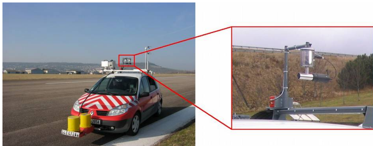
Figure 2 : Véhicule instrumenté et vue détaillée de la sonde de mesure thermo-hygro-métrique
