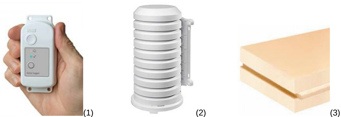
Figure 1 : Matériels intégrés au dispositif de mesures fixes (« stations météo ») : (1) sonde de mesure de température / humidité relative HOB0 MX 2300, (2) abri météo de marque TFA-Dostmann de dimension 60x160 mm et (3) bloc de polystyrène expansé ~10 cm d'épaisseur
