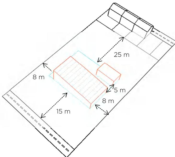
Fig. 3 - Implantation des constructions dans le secteur UAE3-U
