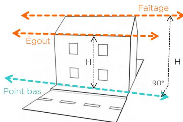
Fig. 12 - Points de référence de la hauteur des constructions en recul des voies
