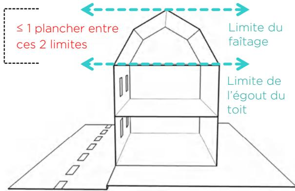
Fig. 15 - Application des règles de hauteur à des terrains en pente
