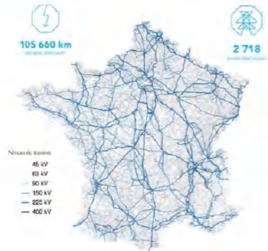
Réseaux de transports électriques français
