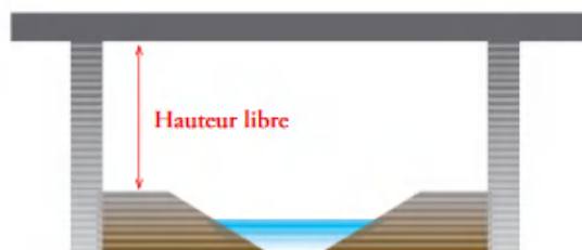
Figure 13 : représentation schématique de la hauteur libre, source : D. Legleye (Cete de Lyon)
