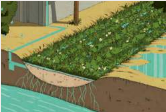
Schémas de principe de la noue végétale avec tranchée drainante et de la planche routière expérimentales.
