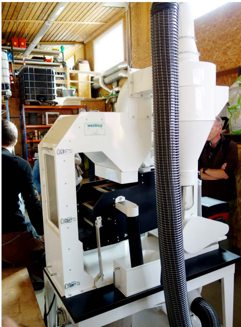
Trieur de semences de petite taille adapté aux semences sauvages.
