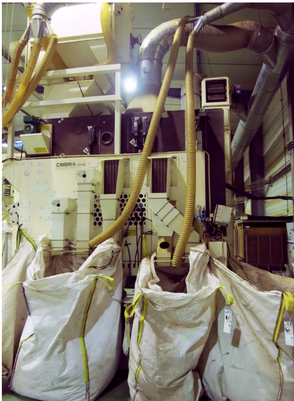
Trieur séparateur de semences avec table densimétrique pour filières « semi-industrielles ».
