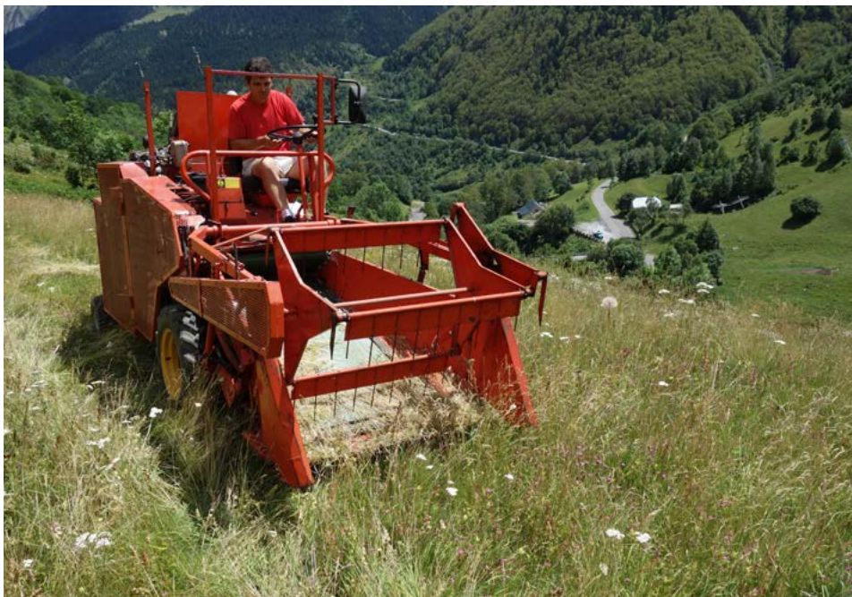
Récolte de semences de plantes sauvages avec une petite moissonneuse-batteuse
