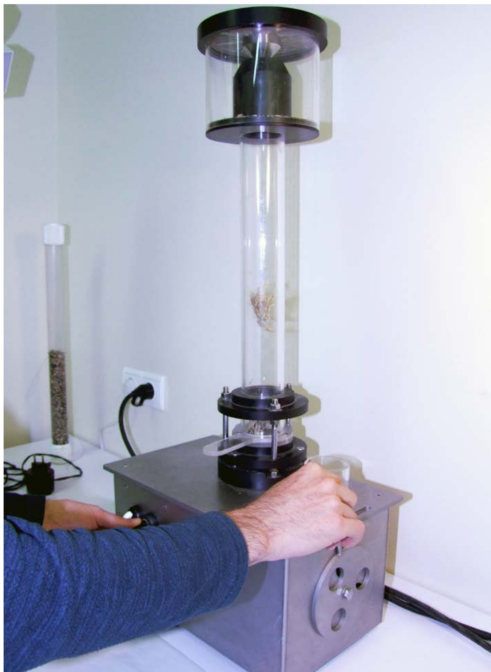
Colonne à air pour le tri de petits lots de semences.
