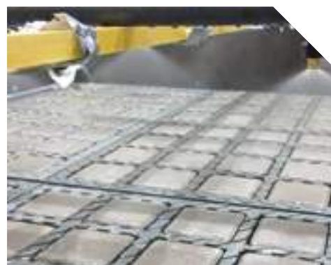
Test de perméabilité avec pluie artificielle sur dalles alvéolées et pavés bétons (© O2D)
