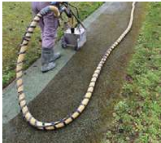
Décolmateuse portable (© CIMBETON référence Guide T69)
