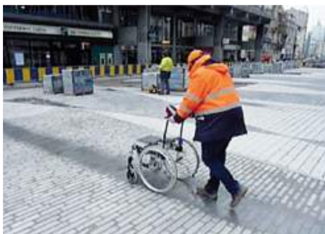
Exemple de mesure de la planéité générée par le revêtement (source : CRR)
