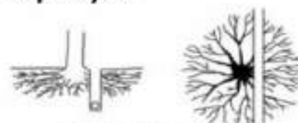
Tranchée altérant les racines
