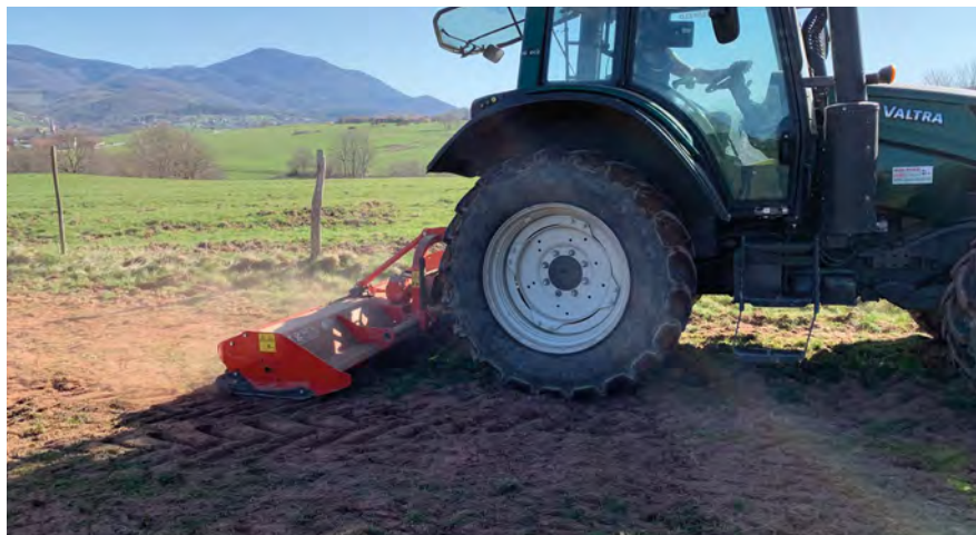
Nivellement du sol par broyeur à refus (ESSAI 2) - 30 mars 2021
