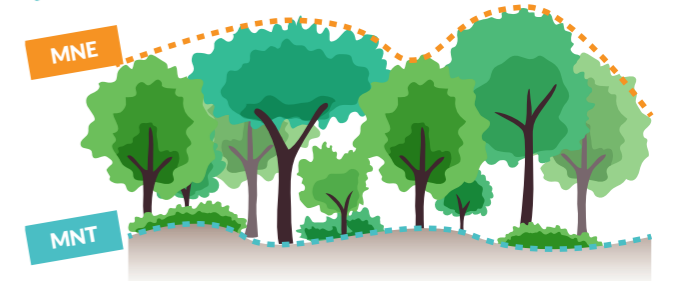
MNT : Modèle Numérique de Terrain (sol) MNE : Modèle Numérique d'Élévation (au-dessus de la végétation) MNC : Surface de la Canopée (MNT-MNS)
