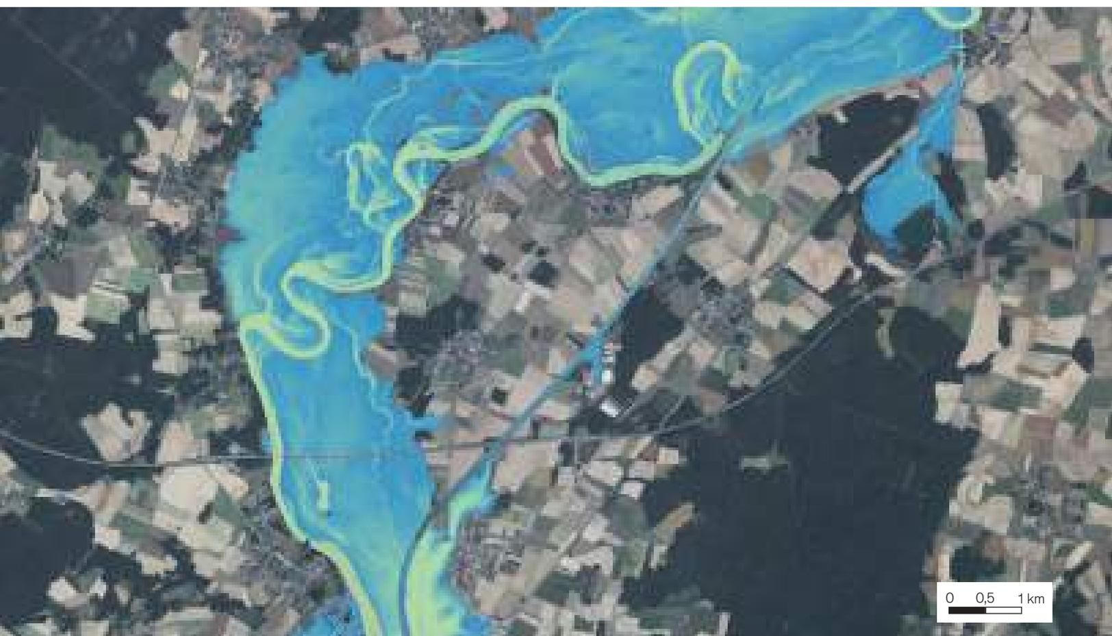
**RECONSTITUTION DE LA CRUE DE LA SAÔNE AVEC UN MODÈLE DE PROPAGATION EN TEMPS RÉEL**
