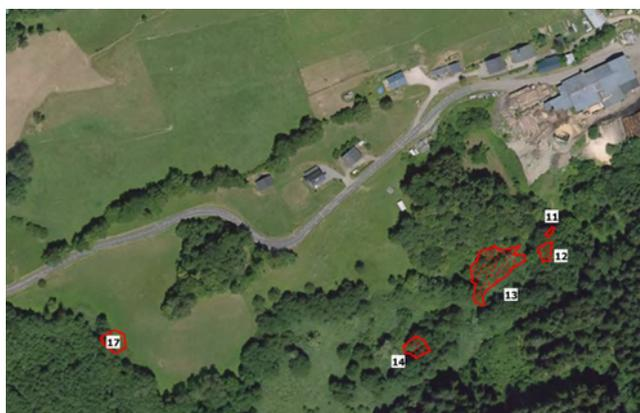
Carte des zones colonisées par des EVEC relevées avec un récepteur professionnel GNSS (extrait d'un DCE travaux). Le repérage des secteurs envahis nécessite un GPS d'une bonne précision pour les projets d'aménagement. Ainsi cet appareil permettra non seulement de bien repérer les zones, mais aussi de faire des estimations fiables des grandes superficies envahies (>50 m<sup>2</sup>) pour analyser les éventuels impacts financiers de la gestion de celles-ci.
