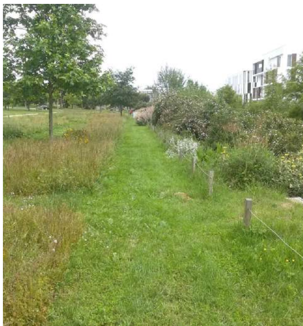
Tonte différenciée et noue végétalisée de collecte des eaux pluviales sur le parc de l'écoquartier de Vidailhan à Balma (31).
