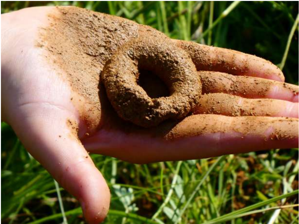
Test du boudin pour déterminer la texture du sol
