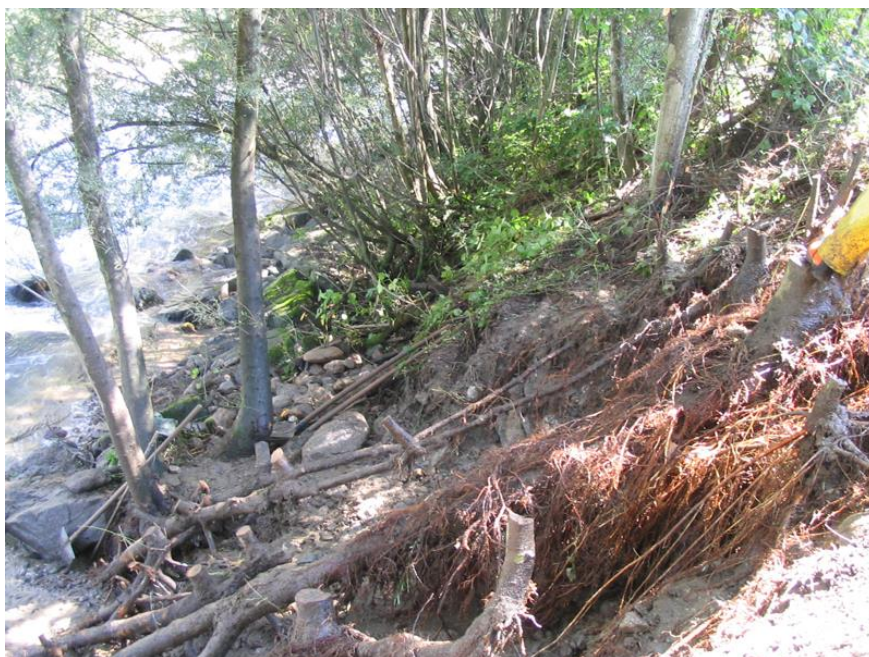
Figure 19 : Berge protégée par une couche de branches à rejet ayant fait l'objet de travaux d'excavation pour observer les tiges et systèmes racinaires développés © Department of hydraulic engineering. Autonomous Provinz of Bozen/Bolzano South Tyrol / Italy.
